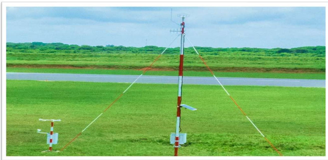
Muonekano wa Mtambo wa kupima Hali ya Hewa unaojiendesha wenyewe (AWS) uliofungwa katika Kiwanja cha Ndege cha Mtwara.
